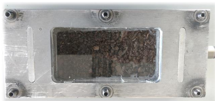
Figura 19. Cámara de ensayo inicial de absorción superficial.
